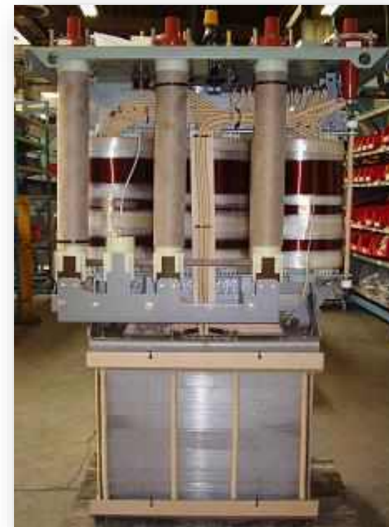
Transformator med P-spole i bunn.
